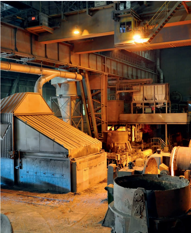
Installierte Absaughaube über Pfannenschlackebox (links) sowie Schlackenmanagement E-Ofenschlacke in Stahlwerkshalle (rechts)
