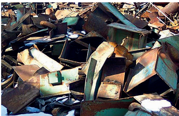
Chargierfähige Schrotte zum Einsatz im E-Ofen der ESF, hier: Alt- und Neuschrotte, Schredderschrott (von links oben nach rechts unten)
