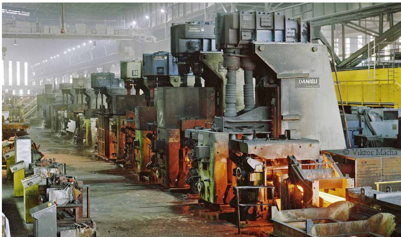
Walzgerüst der Vorstraße im Warmwalzwerk
