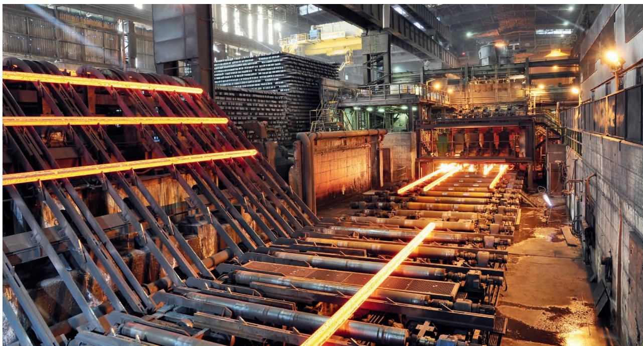
Die Stranggussanlage in Betrieb: Erzeugung von Knüppeln
